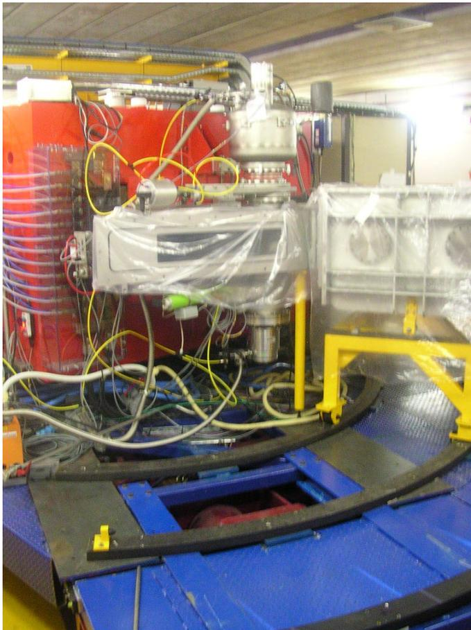
Le dipôle permet de dévier le faisceau d'un angle de  $0^\circ$  à  $90^\circ$  sur une longueur de 1.50 m. Dans le cas que nous étudions, le faisceau est dévié de  $60^\circ$ . Le faisceau sera plus ou moins dévié en fonction d'une grandeur, appelée "Rigidité magnétique" :
